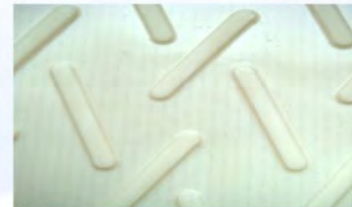
名称：人字形 代码：27 深度：1.8mm 宽度：2000mm 特性：易清洗、适用 斜面输送 行业：烟草 Name:Staggered stud Code:27 Thickness:1.8mm Width:2000mm Property:Incline conveying, easy clean Application:Tobacco
